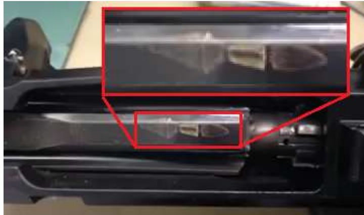
6. L'empreinte de la cartouche en attente dans le magasin indiquant la position de la partie arrière de la culasse au moment de l'explosion. Il n'y a pas de traces de déplacement (ouverture) de la culasse au moment de l'impact.
